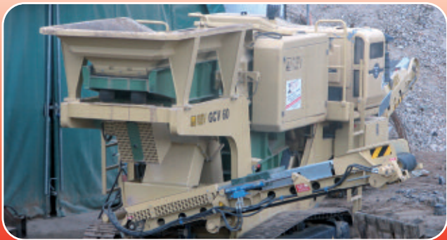
Backenbrecher GCV 60 Raupenmobil ca. 14 to.
