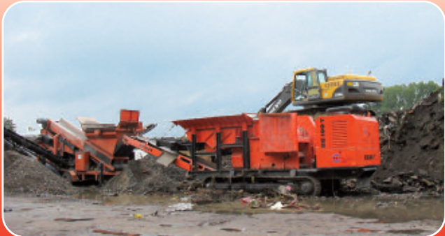
Backenbrecher BAT BB 100 T Raupenmobil ca. 29 to.
